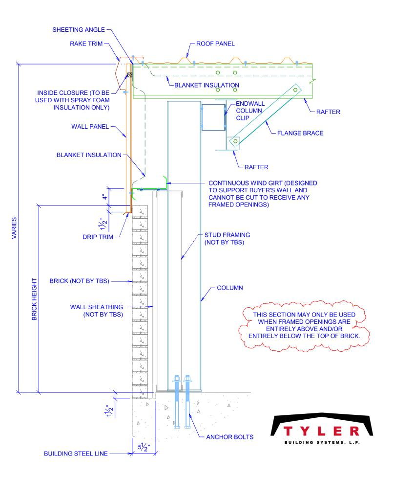
RIGID FRAME ENDWALL SECTION AT PARTIAL BRICK WALL
