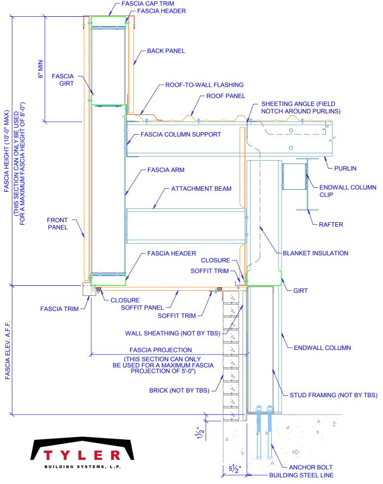
FASCIA SECTION AT RAKE FOR WALL MATERIAL BY BUYER
